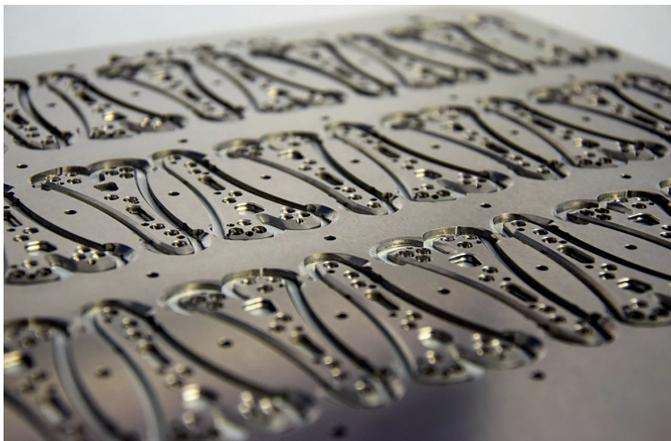
Entgraten und Verrunden der gefrästen Knochenplatten, welche zum Fixieren von gebrochenen Kiefer- und Handknochen gebraucht werden.
