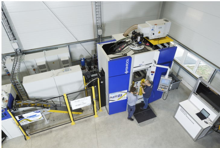
Feinschneidpresse Feintool XFT 2500 speed am Standort Rotter Bruch des WZL (© WZL)
