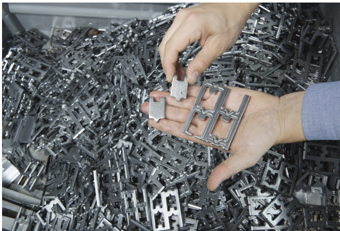
Schnittteile und Stanzabfall von Versuchsteilen mit diversen Geometrielementen (© WZL)
